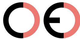
Virheellinen CE-merkki (liian kaukana)
